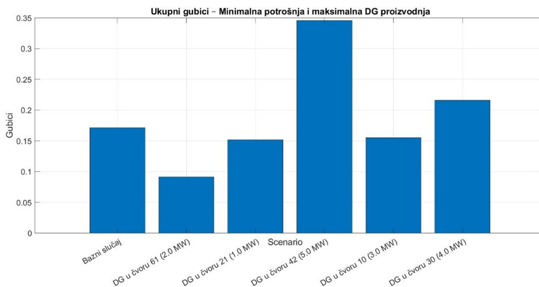
Slika 8: Ukupni gubici u sistemu za bazni slučaj i za 5 scenarija priključenja pri minimalnoj potrošnji i maksimalnoj proizvodnji iz solarnih elektrana
